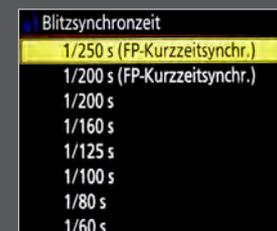
▲ Bei Nikon-Kameras müssen Sie die FP-Kurzzeitsynchronisation entweder zunächst im Menü freischalten, oder Sie können die Funktion direkt am Blitzgerät aktivieren.
