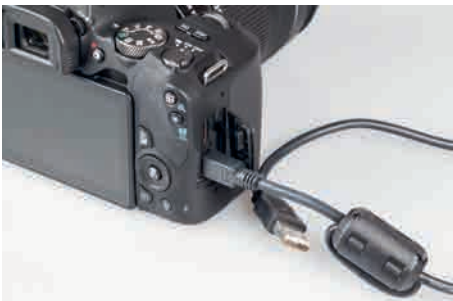
▲ Datenübertragung: USB-Stecker Typ B im DIGITAL-Anschluss der EOS 200D und computerseitiger USB-Stecker Typ A.
