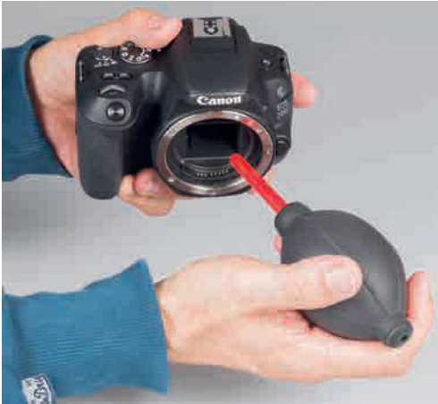
▲ Berührungslose Sensorreinigung mit dem Blasebalg.
