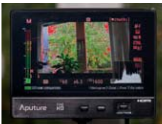
▲ Ein typischer externer 7 Zoll Monitor. Die roten Linien im Bild entstammen dem Focus Peaking oder auch Kantenanhebung. Eine Funktion, die die D7500 selbst gar nicht hat.
