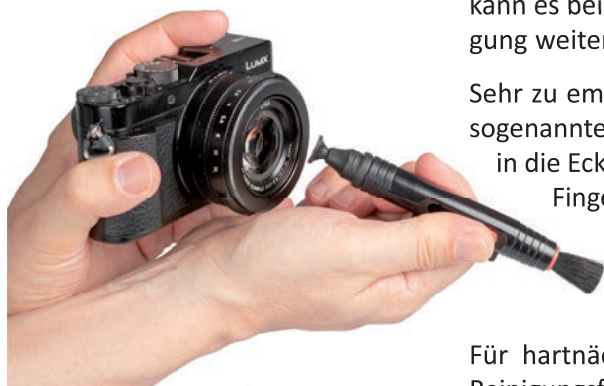
▲ Mit dem Lens Pen lassen sich Objektivverunreinigungen sicher und leicht entfernen.
