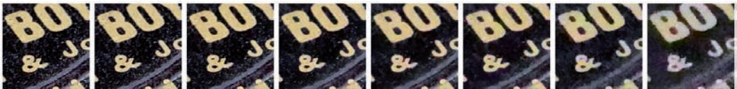
▲ JPEG-Bild mit kamerainterner Rauschunterdrückung (ISO 200, 400, 800, 1600, 3200, 6400, 12800 und 25600).
