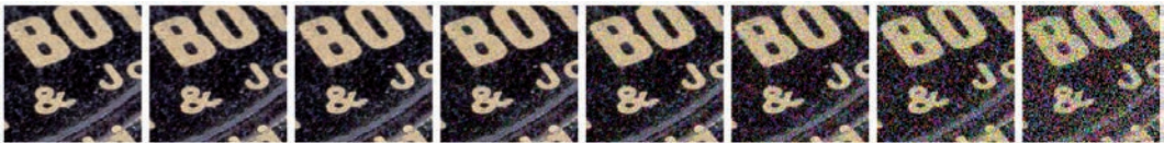
▲ RAW-Aufnahme ohne Rauschunterdrückung (ISO 200, 400, 800, 1600, 3200, 6400, 12800 und 25600).
