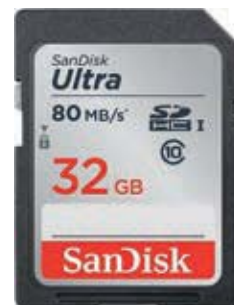
▲ Class 10-Karten erfüllen die Minimalanforderung der α7 III (SanDisk Ultra UHS-I, ca. 18 EUR, Bild: SanDisk).
