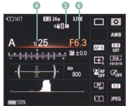
▲ Je höher der Blendenwert, desto höher die Schärfentiefe und desto länger die Belichtungszeit, und umgekehrt. Im Zuge des Einstellens ist der Blendenwert orange dargestellt.
