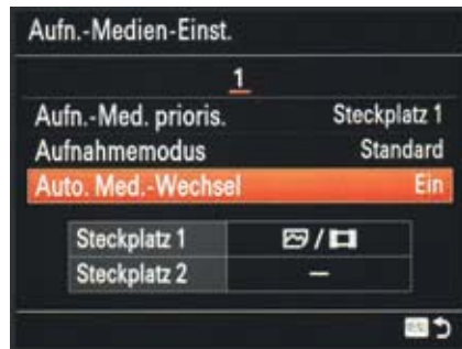
▲ Steckplatz priorisieren und automatischen Kartenwechsel erlauben.
