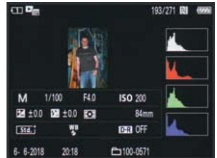
▲ Das Bild ist dunkel, besitzt aber noch Struktur in den Tiefen. Allerdings würde sich beim Aufhellen das Bildrauschen stark erhöhen, daher besser etwas heller belichten.
