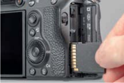
▲ Zwei SD-Karten können in der α7 III eingesetzt werden. SLOT 1 ist der untere und SLOT 2 der obere Steckplatz.
