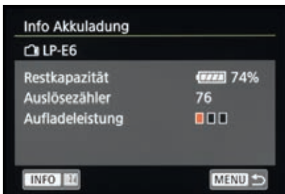
▲ Der alte Akku LP-E6 hat keine gute Aufladeleistung mehr, funktioniert aber noch.
