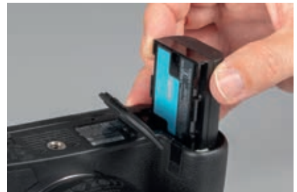
▲ In der EOS R können Akkus vom Typ LP-E6N und LP-E6 verwendet werden.
