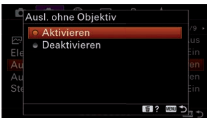
▲ Bei Deaktivierung löst die Kamera nur aus, wenn ein Objektiv mit elektronischen Kontakten angebracht ist.
