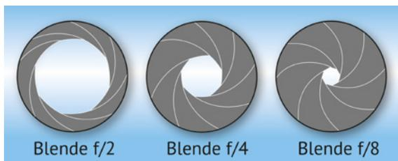
▲ Die Blendenlamellen können sich öffnen und schließen. Dadurch wird die Menge an Licht, die auf den Sensor fällt, und die Schärfentiefe beeinflusst.
